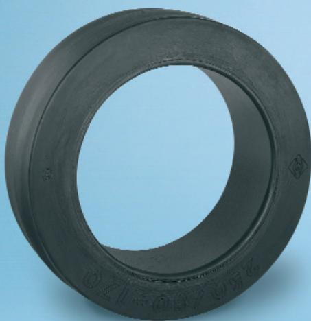
Der Elastic-Belag ist durch einen chemischen Haftvermittler fest mit dem Stahlband verbunden. Stahlbandagen werden auf Guß- oder Stahlkerne aufgepresst, Felgentoleranz nach DIN 7845
