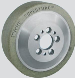
SuperTrac® ist eine Wicke hauseigene Weiterentwicklung der bekannten Vulkollan®-Bereifung (NDI), basierend auf dem Rohstoff Desmodur® 15 der Bayer AG® Leverkusen. Durch die Zugabe von weicheren Elastomerpartikeln haben SuperTrac®-Bereifungen eine vorteilhafte Traktion, speziell im Inneneinsatz, ohne die bewährten Vulkollan®-Eigenschaften in größerem Umfang zu verlieren. Option: Hydrolyseschutz
