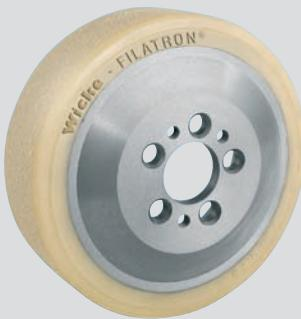
FilaTron® ist eine Wicke hauseigene Weiterentwicklung der bekannten Vulkollan®-Bereifung, (NDI) basierend auf dem Rohstoff Desmodur® 15 der Bayer AG® Leverkusen. Durch die Zugabe von Quarzsandpartikeln haben FilaTron®-Bereifungen eine vorteilhafte Traktion, speziell im Außeneinsatz, ohne die bewährten Vulkollan®-Eigenschaften in größerem Umfang zu verlieren. Option: Hydrolyseschutz
