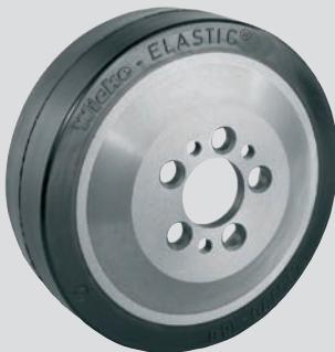
Wicke ELASTIC® -schwarz- ist eine verschleißfeste Gummi-bereifung mit einer Härte von 73 Shore A. Die spezielle Antriebs-qualität bietet hohe Festigkeiten bei geringem Verschleiß und guten Traktionswerten, speziell für angetriebene Einsatz-fälle. Auf Wunsch kann eine Laufradqualität (L) mit geringsten Roll-widerständen alternativ angeboten werden.
