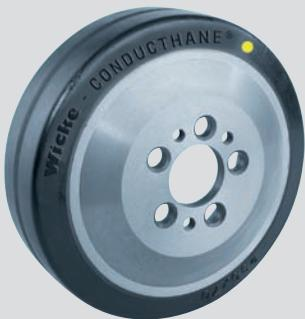
Conductthane® ist eine auf Vulkollan® (NDI) basierende Weiterentwicklung, welche als elektrisch leitfähig, gemäß DIN/EN 12527-33, gilt. Der elektrische Durchgangswiderstand bei ausgelieferten Neuprodukten liegt unter dem Wert von  $10^4 \Omega$ .
