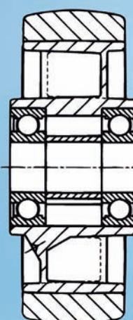
**WICKE-TOPTHANE®** Schwerlasträder mit Polyurethan-Bereifung und Aluminium-Felgen, 92 Shore A Serie PE/Serie PE-FA/Serie PE
